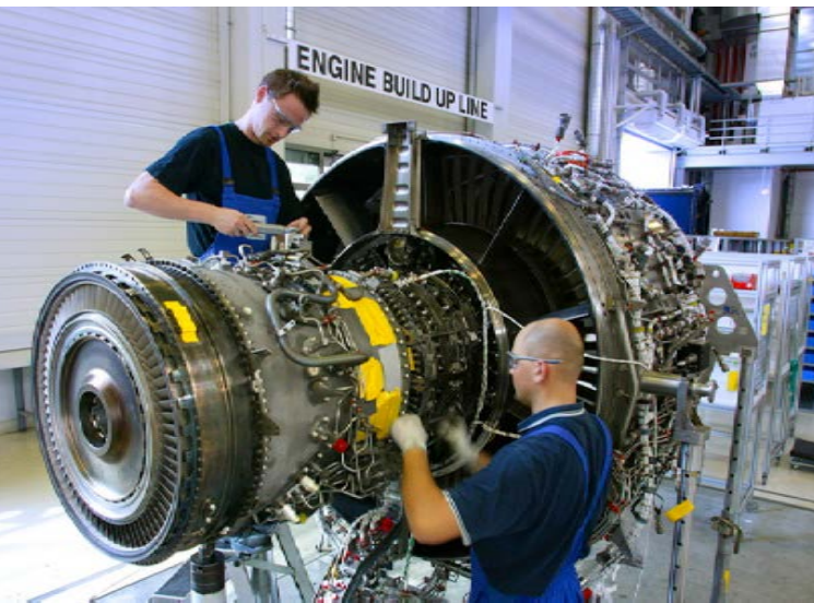
Ein V2500 auf der Flow Line der MTU Maintenance Hannover
