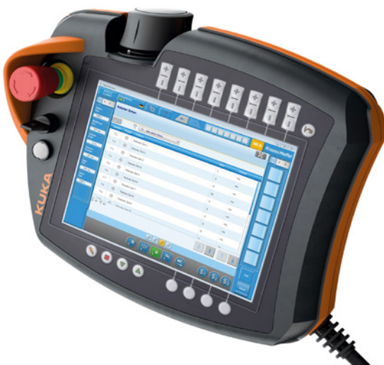
KUKA smartPAD mit dem SpaceMouse® Module: Steuerungs-Sonderlösung von KraussMaffei Automation (Bild KraussMaffei)
